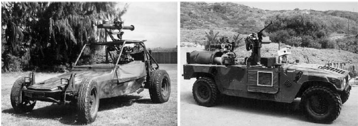
**Figure 6 :** Autres illustrations de véhicules terrestres inhabités. A gauche : le buggy de dune téléopéré TODB. A droite : le véhicule téléopéré TOV.
