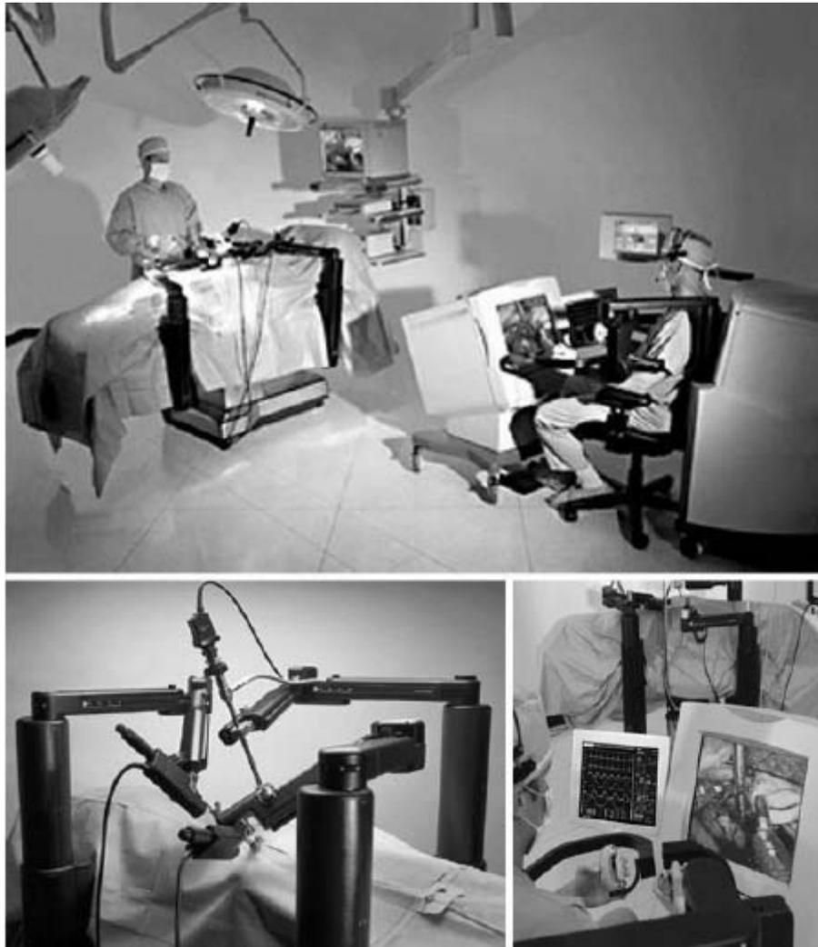
**Figure 9 :** Le système Zeus rendu célèbre lors de l'opération chirurgicale transatlantique « Lindbergh ». En haut : un aperçu de la globalité du dispositif. En bas à gauche : les trois robots manipulateurs. En bas à droite : l'interface de contrôle du chirurgien.
