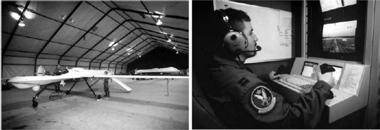
**Figure 3 :** Le UAV Predator transporte une grande variété de capteurs (EO, IR, SAR) et est piloté par un opérateur au sol via une liaison radio ou satellite. Il peut exécuter un plan de vol de manière totalement autonome une fois celui-ci implémenté à bord. A gauche : l'US Air Force Predator. A droite : la station de contrôle du Predator.
