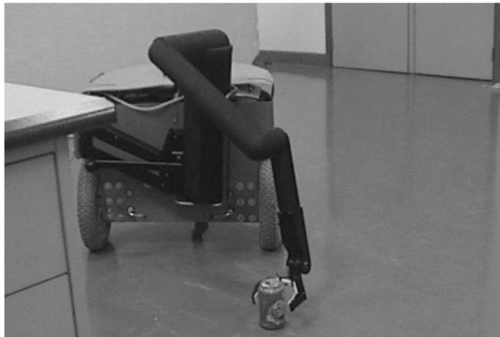
**Figure 10 :** Le robot ARPH est composé d'une plate-forme mobile sur laquelle est embarqué un bras manipulateur. Son but est d'augmenter l'autonomie des personnes à mobilité réduite.
