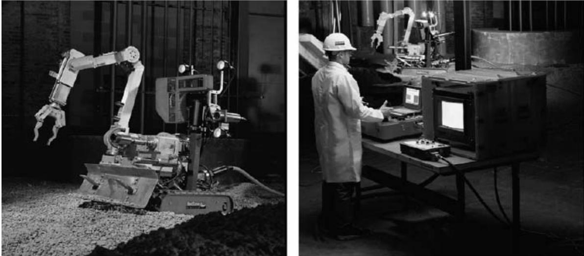
**Figure 7 :** Le robot Pioneer a été conçu pour inspecter et diagnostiquer l'état du réacteur nucléaire de Chernobyl. A gauche : le robot Pioneer. A droite : sa station de contrôle.
