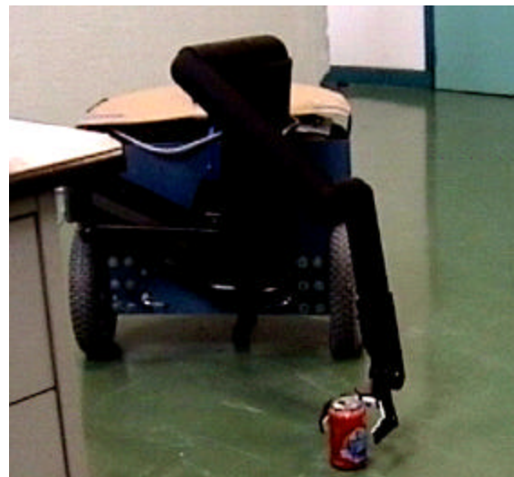
Fig.1. Représentation du porteur équipé du bras Manus, lors d'une tâche de saisi au sol.
