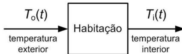
Figura 2.5 – Esquema funcional da instalação do Exemplo 2.2.
