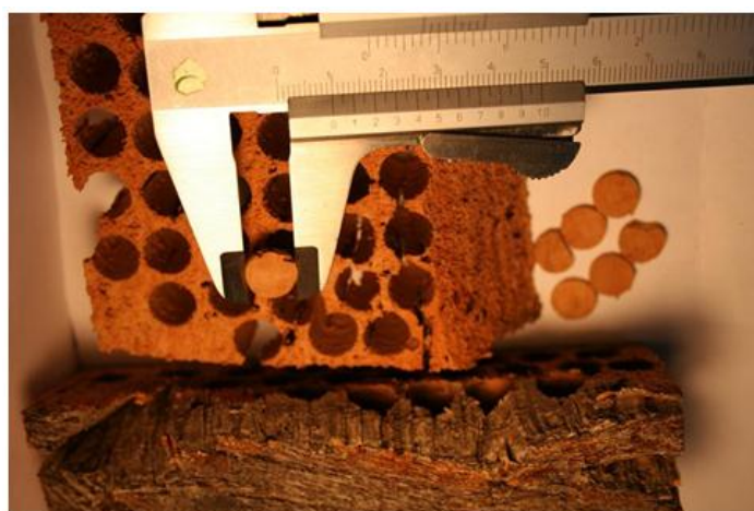
Figura 5.3 – Discos de cortiça semelhantes aos utilizados nos ensaios, retirados das pranchas de reprodução amadia.
