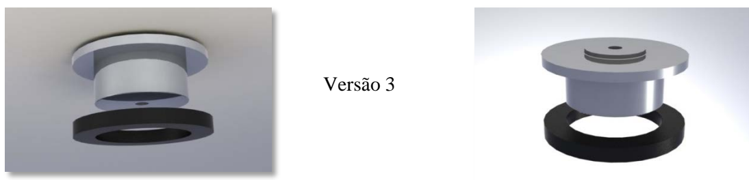
Figura 4.14 – Versão final das anilhas utilizadas nas fugas de R134a. No lado esquerdo verifica-se o encaixe da anilha de neopreno, que estará em contacto com o gargalo do frasco, na anilha metálica. Do lado direito mostra-se a saliência da anilha que estará em contacto com a membrana.
