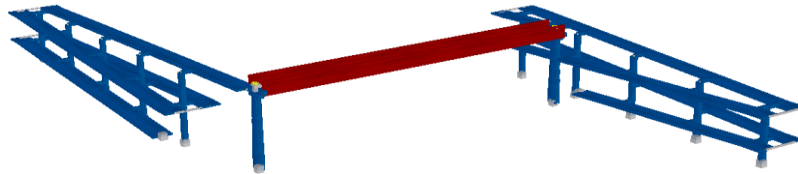
Figura 6- Modelo tridimensional do passadiço em SismoStruct
