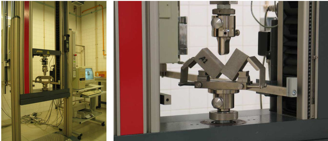
Figura 7.7: Equipamento e pormenor do ensaio de tracção por flexão do provete A1
