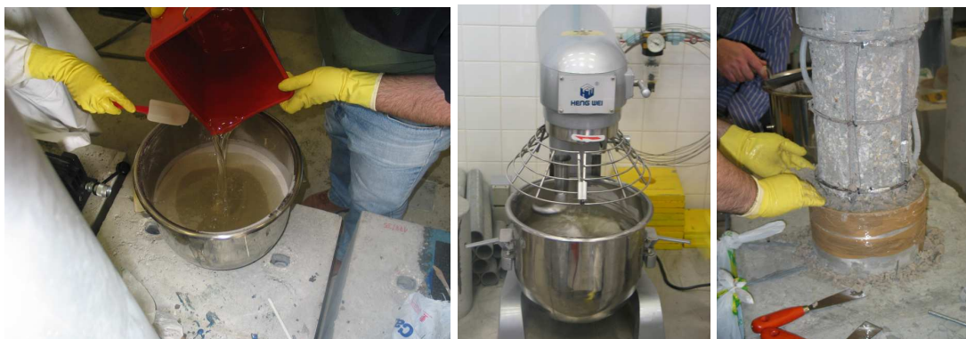
Figura 7.1: Preparação e aplicação do betão polimérico no pilar P2R
