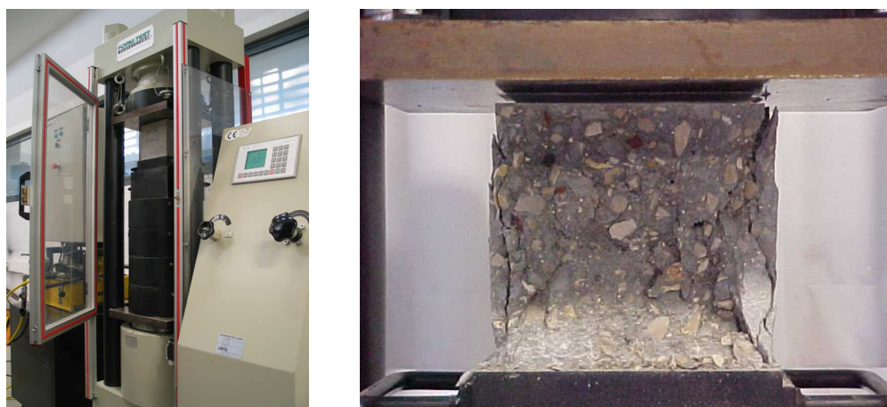
Figura 3.1: Prensa de compressão e pormenor da rotura de um cubo de betão
