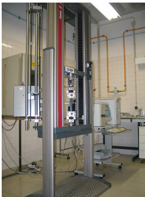
Figura 5.1: Máquina de tracção do LabDEC utilizada no ensaio dos provetes de FRP
