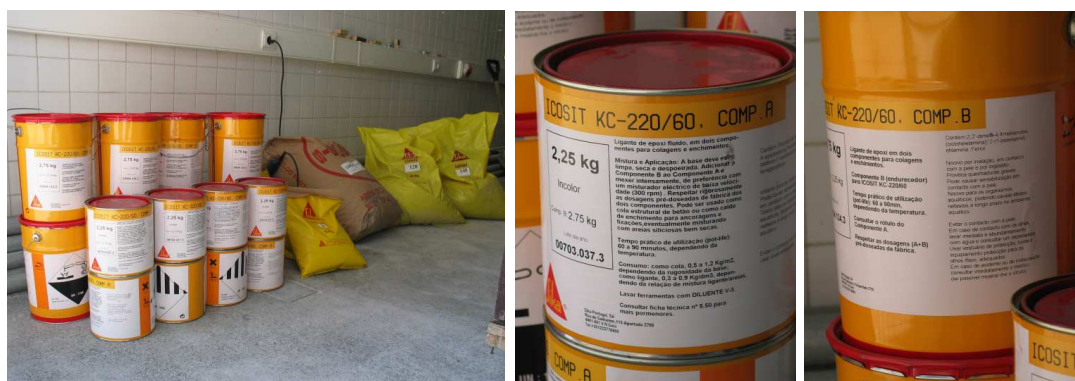
Figura 7.3: Materiais da Sika utilizados no reforço da sapata do pilar P10
