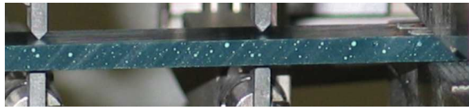
Figura 4.1: Pormenor transversal de um provete de resina com micro bolhas de ar
