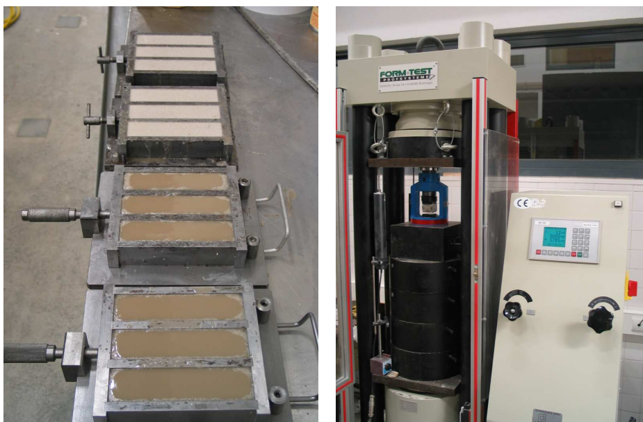
Figura 7.6: Bateria de moldes com os provetes das séries C e D e prensa do LabDEC utilizada no ensaio dos provetes
