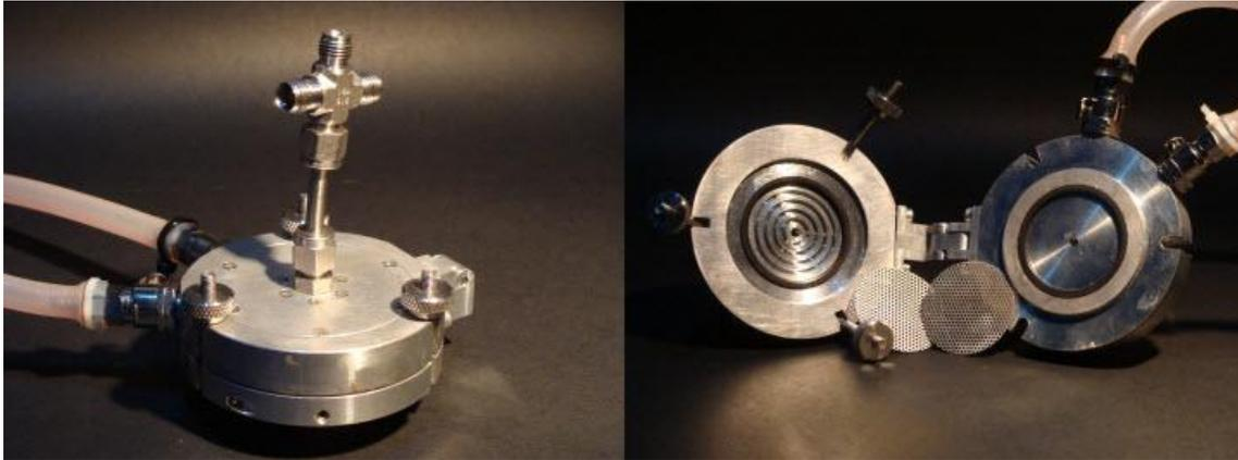
**Figura 4.3:** Porta-amostras utilizado nos ensaios de determinação do coeficiente de permeabilidade das membranas ao gás R-134a. No interior do porta-amostras encontra-se um circuito de refrigeração que permite uma boa estabilidade térmica durante a realização dos ensaios.
