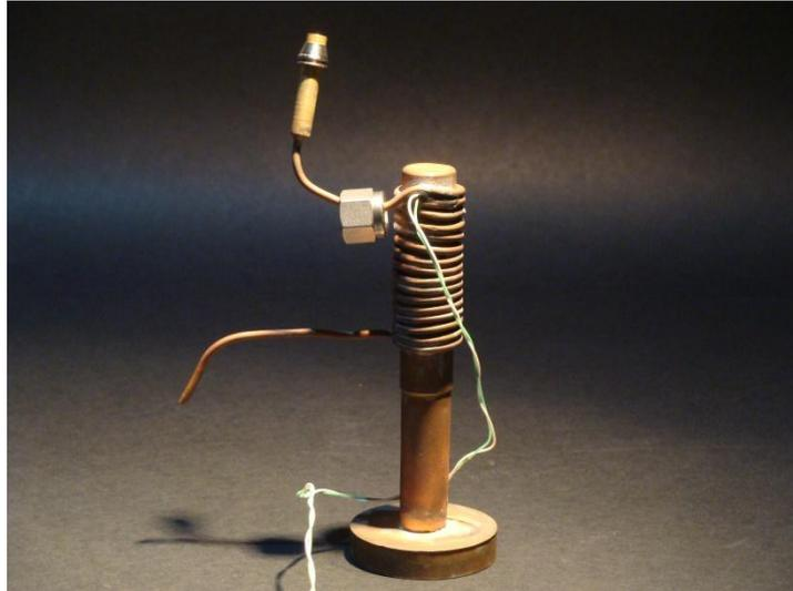
**Figura 5.3:** Peça construída para o novo sistema de enchimento de fugas que permite a liquefação do gás. Para uma boa condutividade térmica a peça é construída em cobre e as peças soldadas a prata.
