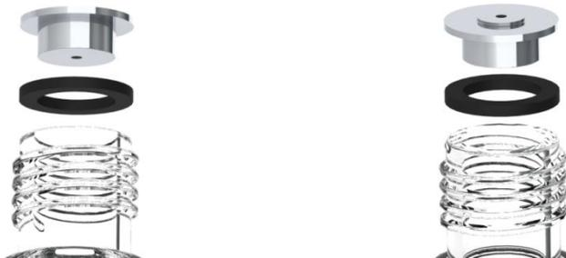
**Figura 5.7:** Versão final do sistema de vedação das fugas de R-134a. No lado esquerdo observa-se o encaixe da anilha de neoprene que está em contacto como gargalo do frasco. No lado direito é possível observar a saliência da anilha que está em contacto com a membrana de permeação.
