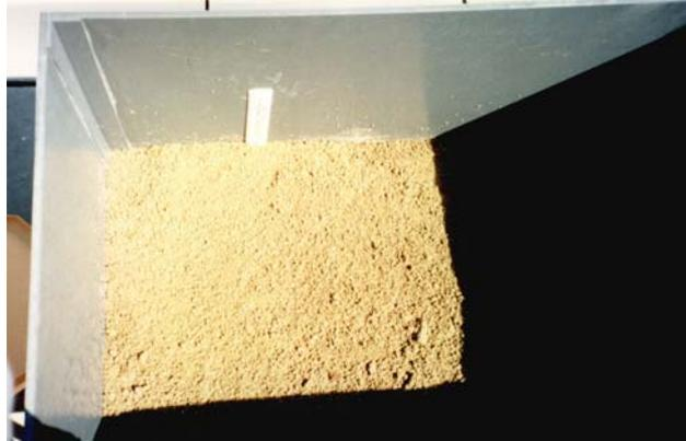
**Figura 8.6** Camada de solo crivado colocada sobre a camada drenante do material silicioso
