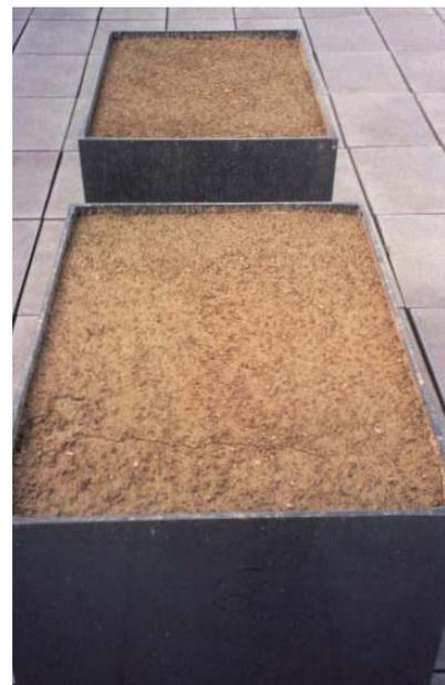
**Figura 8.7** Remoção dos materiais monolíticos dos moldes originais para posterior pesagem e colocação nos pilotos (à esquerda) e aspecto dos pilotos P5 e P6 após a colocação da camada superficial de solo crivado (à direita)
