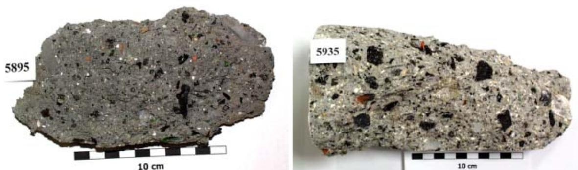
**Figura 5.1 Aspecto macroscópico da estrutura interna dos materiais 5895 (à esquerda) e 5935 (à direita), desenvolvidos, respectivamente, para o enchimento de antigas minas ou pedreiras e para construções no sub-solo (imagens oficiais do projecto VALOMAT, gentilmente cedidas pelo Ibac – Universidade Técnica de Aachen)**
