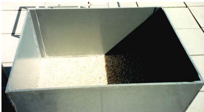
**Figura 8.5** Camada drenante de material silicioso colocada no fundo dos pilotos P5 a P7
