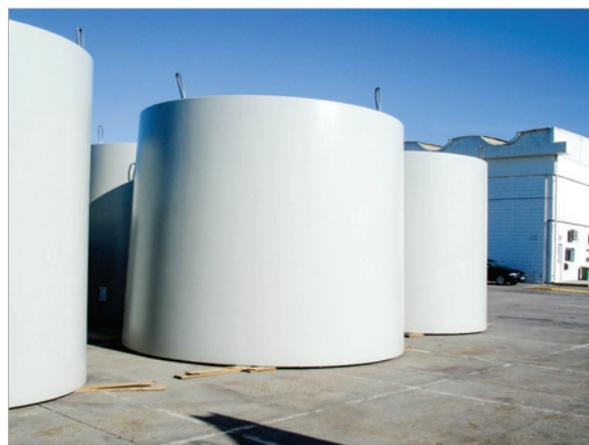
Figura 19 – Anéis pré-moldados com juntas horizontais (fonte: Enercon)
