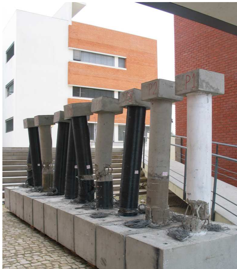
Figura 8.1: Vista geral dos pilares P1 a P10 após o ensaio
