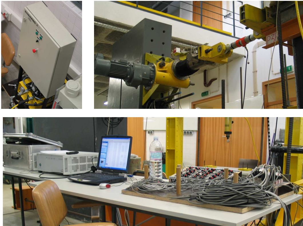
Figura 4.1: Bomba hidráulica, actuador mecânico de parafuso e mesa de comando
