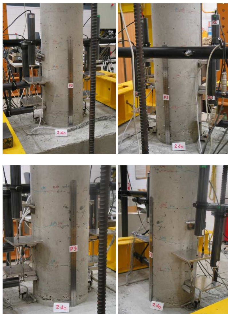
Figura 6.2: Pormenores da fendilhação observada nos pilares P2 e P3 para 2d_0
