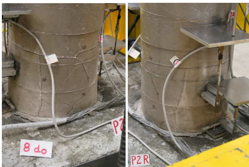
Figura 6.3: Pormenores da fendilhação observada no pilar P2R
