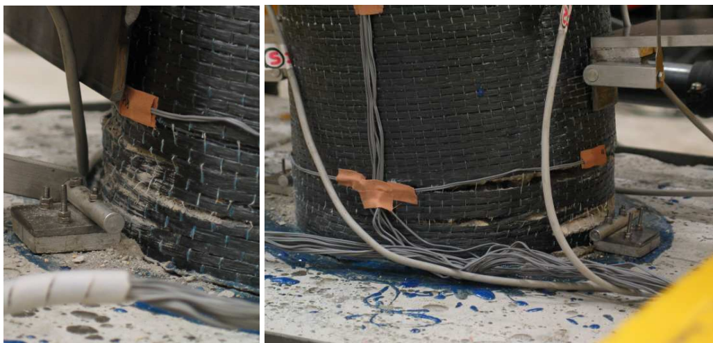
Figura 8.10: Pormenores do estado de degradação do colete e da grande abertura de fendas observada após o ensaio do pilar P6
