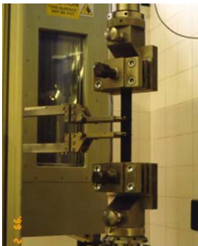
Figura 1: Pormenor do ensaio de um provete de resina.
