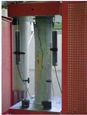
Figura 10: Fotos de alguns modelos sem CFRP após ensaio: i) sem armaduras; ii) com armaduras
