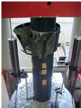
Figura 11: Fotos de alguns modelos com CFRP após ensaio: i) sem armaduras; ii) com armaduras
