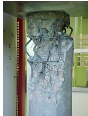
Figura 10: Fotos de alguns modelos sem CFRP após ensaio: i) sem armaduras; ii) com armaduras
